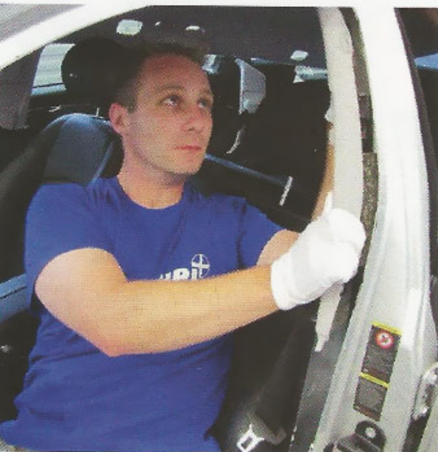
Um direkt an der Beschädigung arbeiten zu können, müssen oft Innenverkleidungen demontiert werden.
